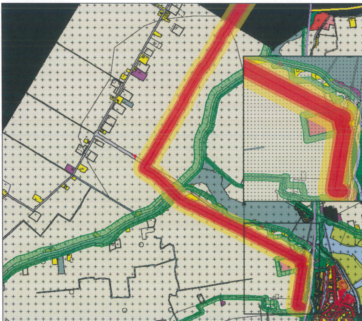
Figuur 2: visualisatie afstanden hittestraling van het scenario fakkelbrand hogedruk aardgastransportleiding
