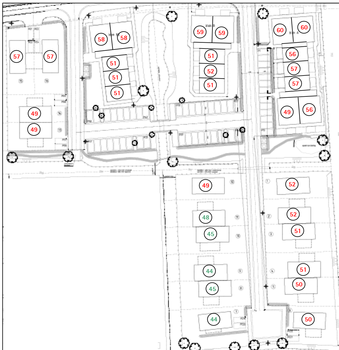
Figuur 4.1: Maatgevende geluidbelasting (uitgedrukt in dB, groene waarden voldoen aan de Wgh, rode waarden voldoen niet aan de Wgh)
