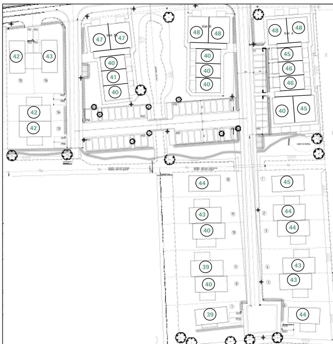
Figuur 4.3: Maatgevende geluidbelasting na toepassing van een scherm langs de N247 (uitgedrukt in dB, groene waarden voldoen aan de Wgh, rode waarden voldoen niet aan de Wgh)
