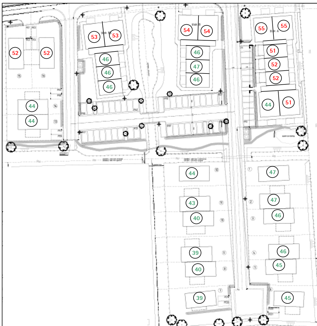
Figuur 4.2: Maatgevende geluidbelasting na toepassing van stil asfalt (uitgedrukt in dB, groene waarden voldoen aan de Wgh, rode waarden voldoen niet aan de Wgh)
