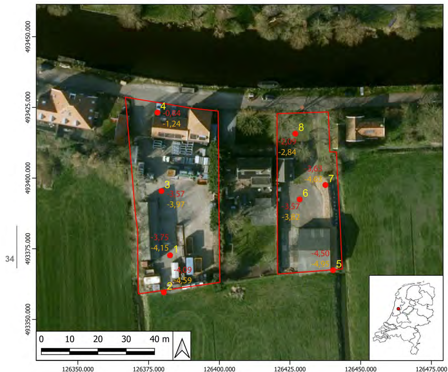
Afbeelding 19. Overzichtskartaal van de deellocaties met de boorpunten (geel), de maaiveld hoogte t.o.v. NAP (rood) en de dieptes t.o.v. NAP waarop de boringen zijn gestaakt (oranje), met uitzondering van boring 2, waar het oranje getal de NAP-hoogte van de onderkant van de recente bouwvoor is. Tot op de oranje dieptes kan vrij worden verstoord zonder eventuele archeologische resten te raken.
