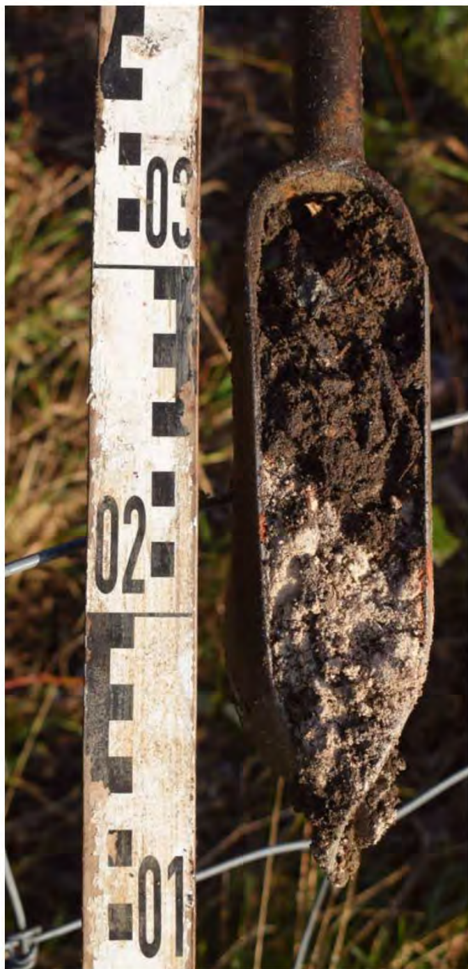
Afbeelding 17. De witte laag in boring 5 met daarin een concentratie kalkmortel met puin- en baksteenfragmenten tussen 0,20 en 0,45 m -mv.
