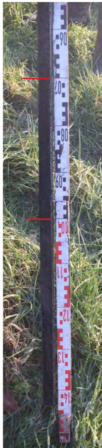
Afbeelding 18. Foto van boring 2 met de overgang van het laagpakket van Walcheren naar het Hollandveen op ca. 0,70-0,75 m -mv en daaronder de overgang van het Hollandveen naar het laagpakket van Wormer op ca. 1,00 m -mv.
